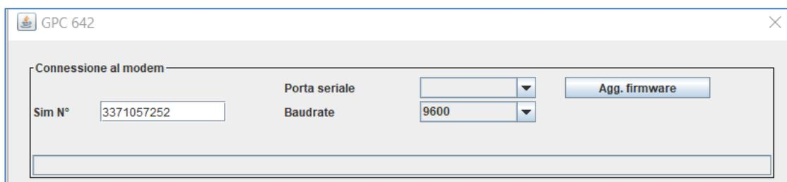
2. Inserire il numero della SIM da chiamare, la porta seriale a cui è collegato il modem e la velocità di comunicazione dello stesso, e cliccare il pulsante *Agg. Firmware*: il modem invierà al GPC 642 un SMS per l'aggiornamento del suo software.
